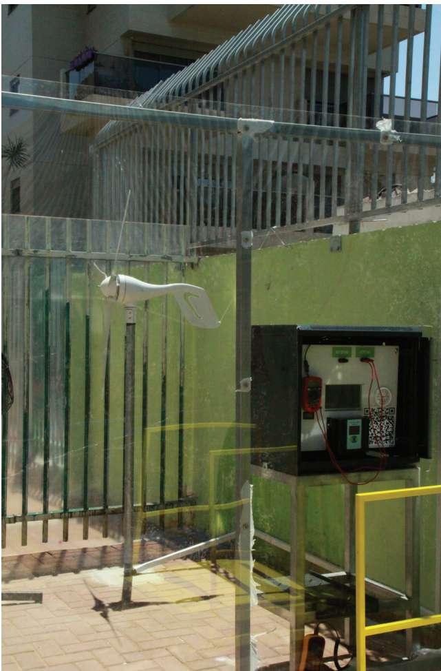
איור 4: מתקן להפקת אנרגיה חשמלית הפועל על ידי טורבינת רוח
